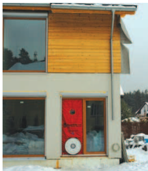
Urządzenie Blower Door w miejscu drzwi tarasowych w domu pasywnym w Boruszowicach koło Tarnowskich Gór
